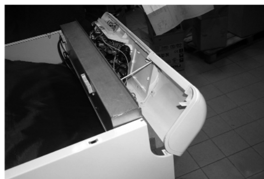
Fig. 6 - Girar hacia adelante el panel de mandos.
