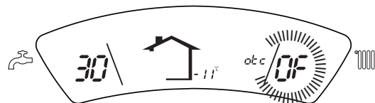
fig. 12 - Desplazamiento paralelo de las curvas
