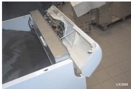
Fig. 6 - Girar hacia adelante el panel de mandos.
