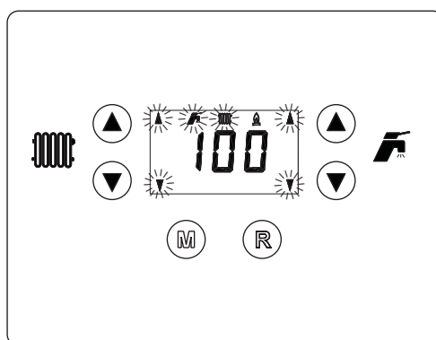
fig. 25 - Modalidad TEST (potencia de la calefacción = 100%)
